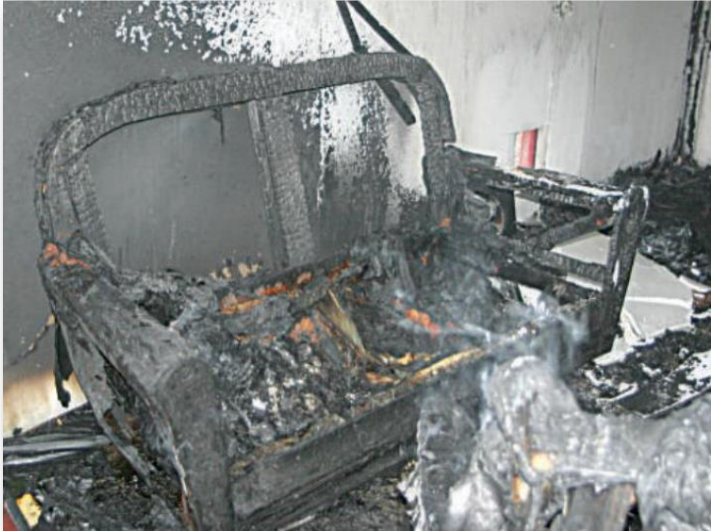
FIGURA 6.3.9.2 Mayor pérdida de masa en el brazo derecho de este sillón para dos personas que en el brazo izquierdo.
