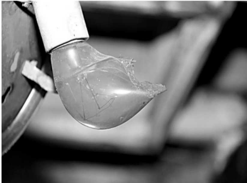
FIGURA 6.3.6.2 (a) Una bombilla "tirada" típica que muestra que el calentamiento se realizó del lado derecho.
