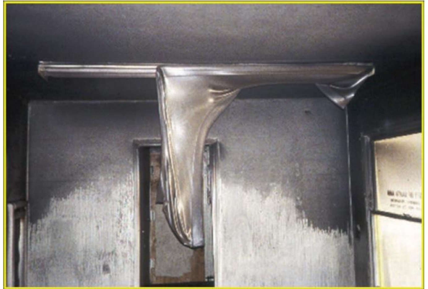
FIGURA 6.3.10.4(b) Pantalla fluorescente indicando desplazamiento del calor de izquierda a derecha.
