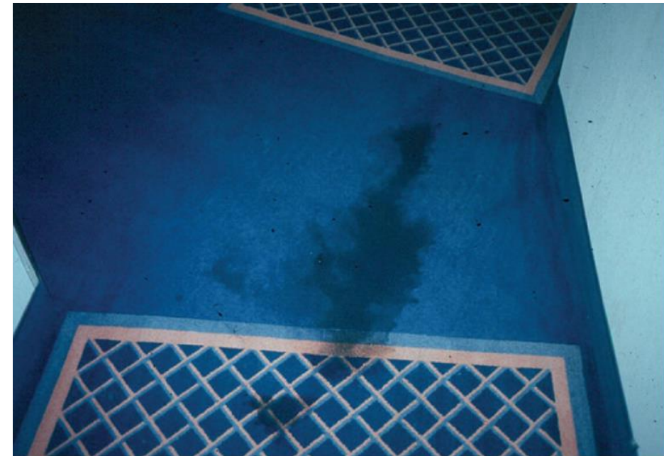
FIGURA 6.3.20.7.3(b) Patrón de forma irregular en la alfombra como resultado de la combustión de un líquido inflamable.
