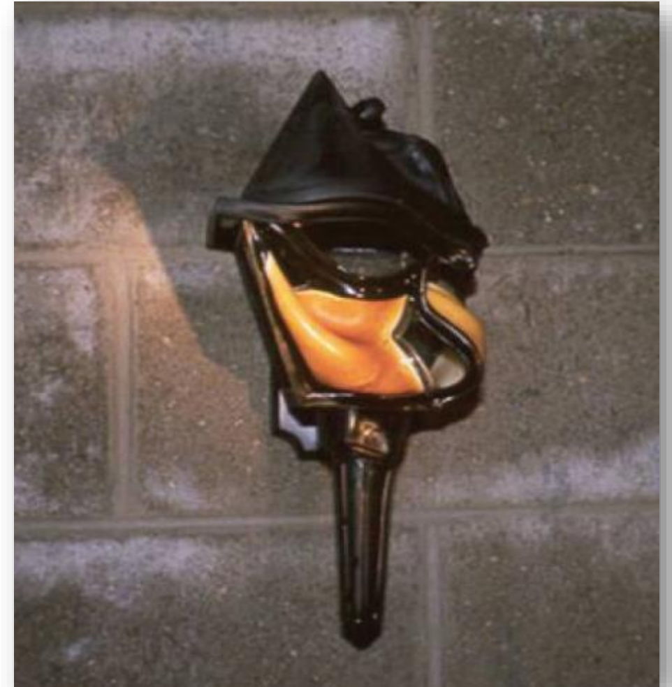
FIGURA 6.3.10.4 (a) Aplique de plástico fundido, indicando que el calor se movía de derecha a izquierda.
